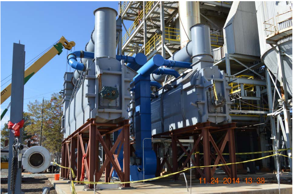
Two GMax Gasifiers installed to drive a 150,000 #/hr HRSG
